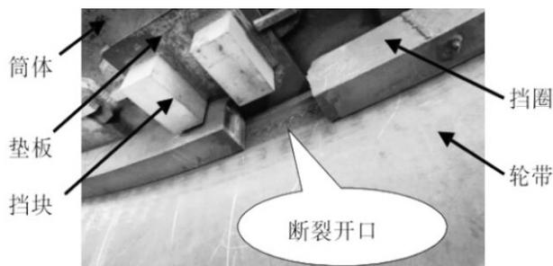
图 3 热膨胀间隙过小导致整体挡环崩裂
