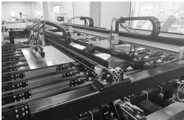
旋转定位装置及助剂涂抹装置
