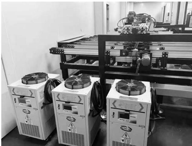
探孔检测装置及激光冷水机
